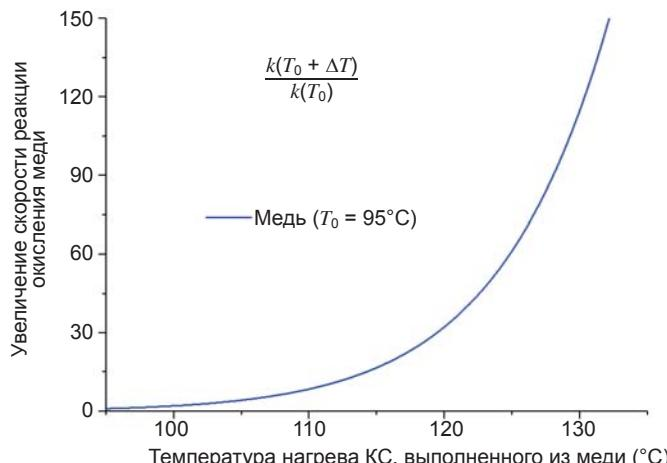
Рис. 4. Зависимость относительного увеличения константы скорости реакции окисления медного контактного соединения при росте температуры нагрева выше установленного значения допустимой температуры нагрева
