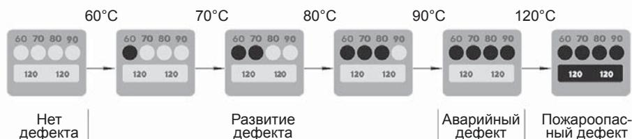
Рис. 6. Методология оценки состояния контактов (контактных соединений) по результатам осмотра для выявления «аварийных дефектов» и «пожароопасных дефектов»
