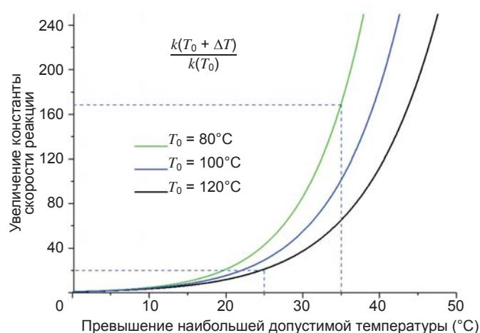
Рис. 5. Зависимость относительного увеличения константы скорости реакции окисления контактных соединений при превышении наибольшей температуры нагрева
