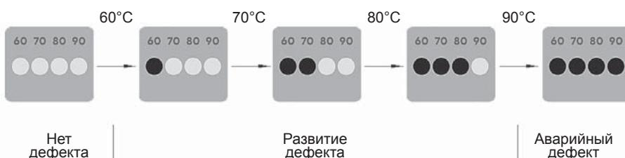
Рис. 3. Принцип работы и применения необратимых термоиндикаторных наклеек для оценки состояния контактов (контактных соединений)
