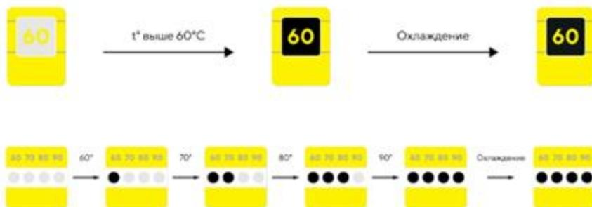
**Рис. 1.** Внешний вид и принцип работы ТИН
