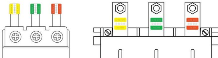
**Рис. 2.** Способ установки ТИН *на поверхность* контактов и контактных соединений электрооборудования
