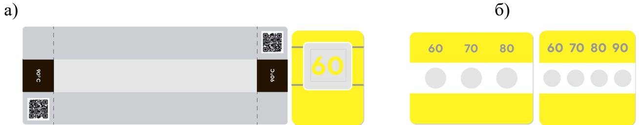
Рис. 1. Внешний вид однотемпературных (а) и многотемпературных (б) термоиндикаторных наклеек.
